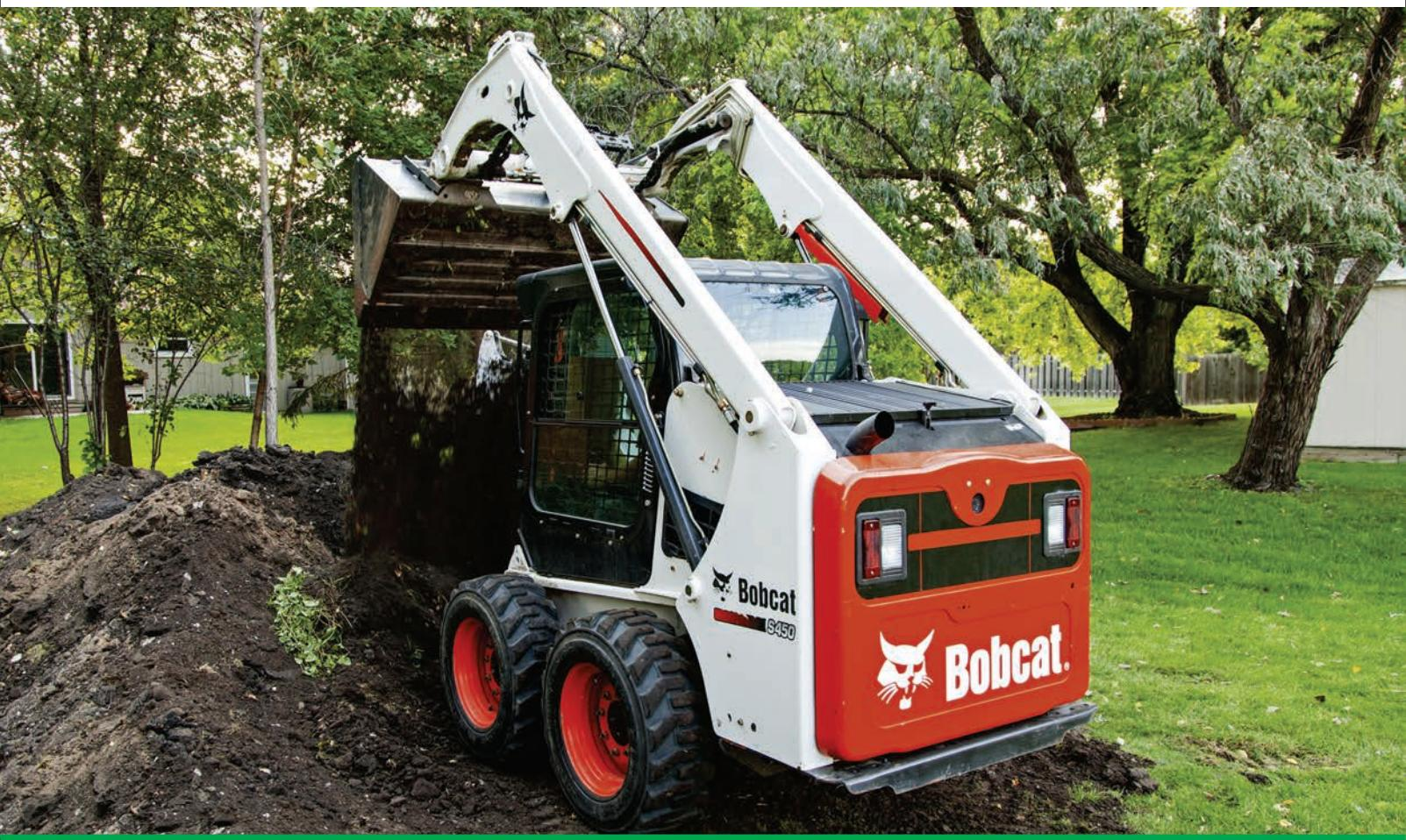
Малые мини погрузчики Bobcat с бортовым поворотом Bobcat находят применение в разных областях сельского хозяйства. Маневренность и компактность позволяют использовать их для различных фермерских работ. Благодаря своему радиусу подъема груза, короткой колесной базе машина идеально подходит для выполнения погрузочно-разгрузочных работ в местах, слишком тесных для другого оборудования.
